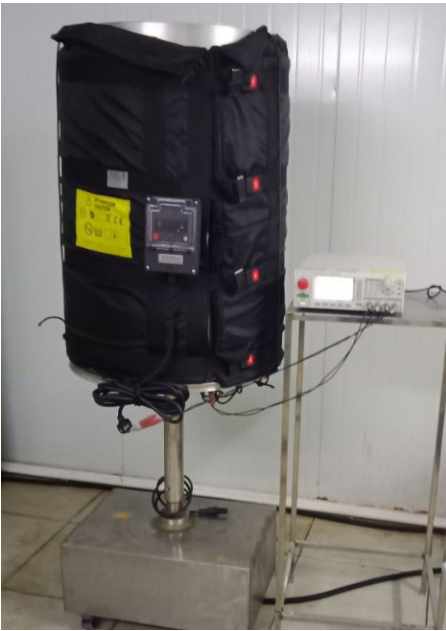
IPx6 测试后的绝缘电阻测量
